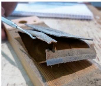
Bild 1 zeigt, wie durch starke Verschmutzung und durch Verschleiß das Instrument in seiner Funktion erheblich beeinträchtigt war. Alle der rund 1500 Ledermembranen (Bild) sind im Zuge der Arbeiten ausgetauscht worden, um
