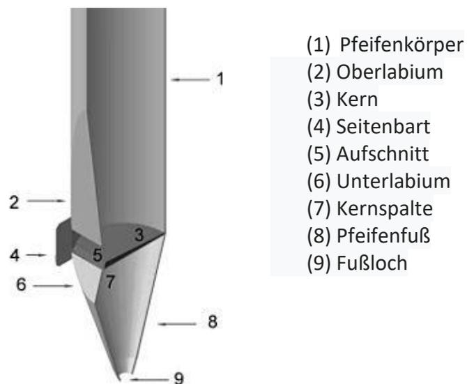
Die Tonerzeugung der Labialpfeifen beruht darauf, dass ein Luftband durch einen schmalen Spalt gegen eine Kante, das Labium, geblasen wird. Dies entspricht dem Prinzip der Blockflöte und anderer Schnabelflöten. Die Länge der Pfeife bestimmt bei den Labialpfeifen direkt die Tonhöhe.
