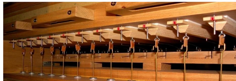
Ein **Register** ist bei einer Orgel eine in der Regel über den gesamten Tonumfang reichende Reihe von Pfeifen gleicher Klangfarbe, die als Einheit ein- oder ausgeschaltet werden kann. Bei den meisten Registern klingt pro Taste genau eine Pfeife; sogenannte gemischte Stimmen bestehen dagegen aus mehreren Pfeifenreihen (auch englisch ranks). In der Regel ist jedes Register einer Klaviatur fest zugeordnet.
