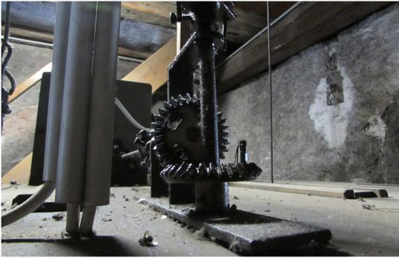
Über eine Serie von Antriebswellen wird die Kraft über mehrere Stockwerke hinauf zu den 4 Zifferblättern geleitet.
