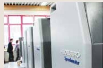
**Vierfarbendruck.** Der Bogen läuft durch vier Walzentürme durch.
