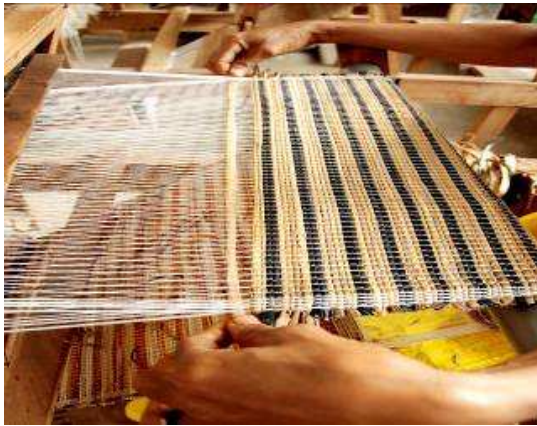
Die mit Naturfarben eingefärbten und getrockneten Fasern werden mit dem Webstuhl verwoben.
